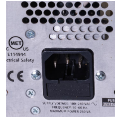
Módulo de entrada de energía
