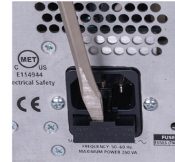
Extracción de portador de fusibles
